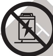
Не размещайте аккумуляторную батарею на токопроводящих предметах.
