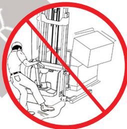
Не используйте погрузчик на скользкой дороге. (например, дороги с масляными пятнами, тающим снегом или дороги, покрытые льдом)
